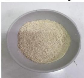
Gambar 2. Hasil Sintesis *Chitosan* dari Limbah Cangkang Kulit Udang
