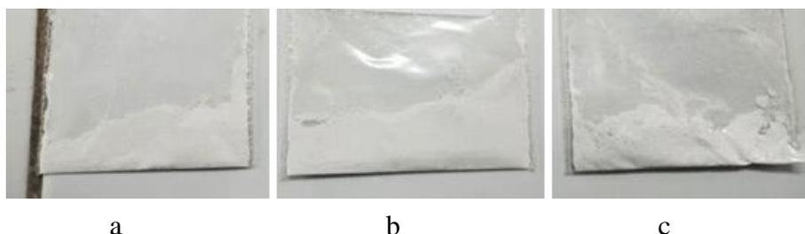
Gambar 1. Serbuk Np - CaO dengan perbandingan ekstrak etanol daun salam dan cangkang telur terkalsinasi (a) variasi A (3:7), (b) variasi B (5:5), dan (c) variasi C (7:3) v/v
