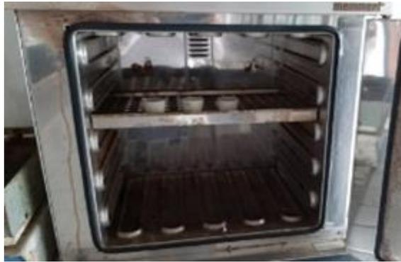
Gambar 2. Pengujian lengas tanah
