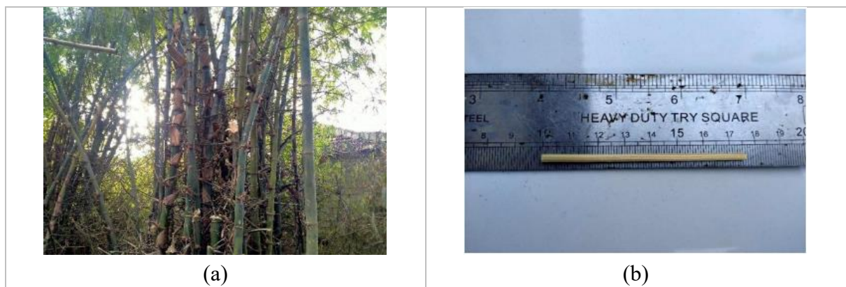
Gambar 3. (a) Jenis Bambu Duri, (b) Cerucuk Bambu Panjang 7,5 cm
