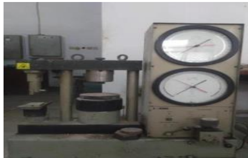
Gambar 5. Alat uji kekuatan tekan
