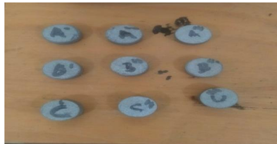
Gambar 6. Spesimen uji kekerasan setelah di sintering
