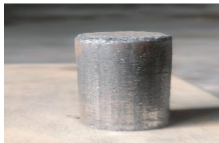
Gambar 7. Spesimen uji kekuatan tekan setelah di sintering
