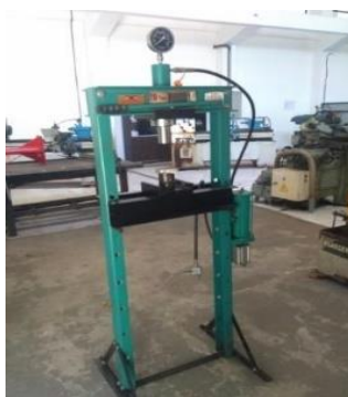
Gambar 1. Alat kompaksi satu arah
