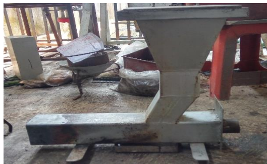
Gambar 6. Hasil fabrikasi burner biomassa.
