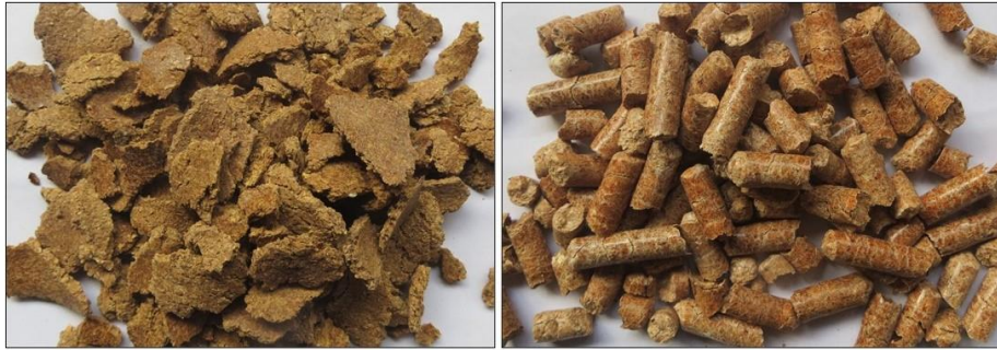
Gambar 1. Limbah nyamplung dan pelet kayu yang digunakan pada uji performa burner.
