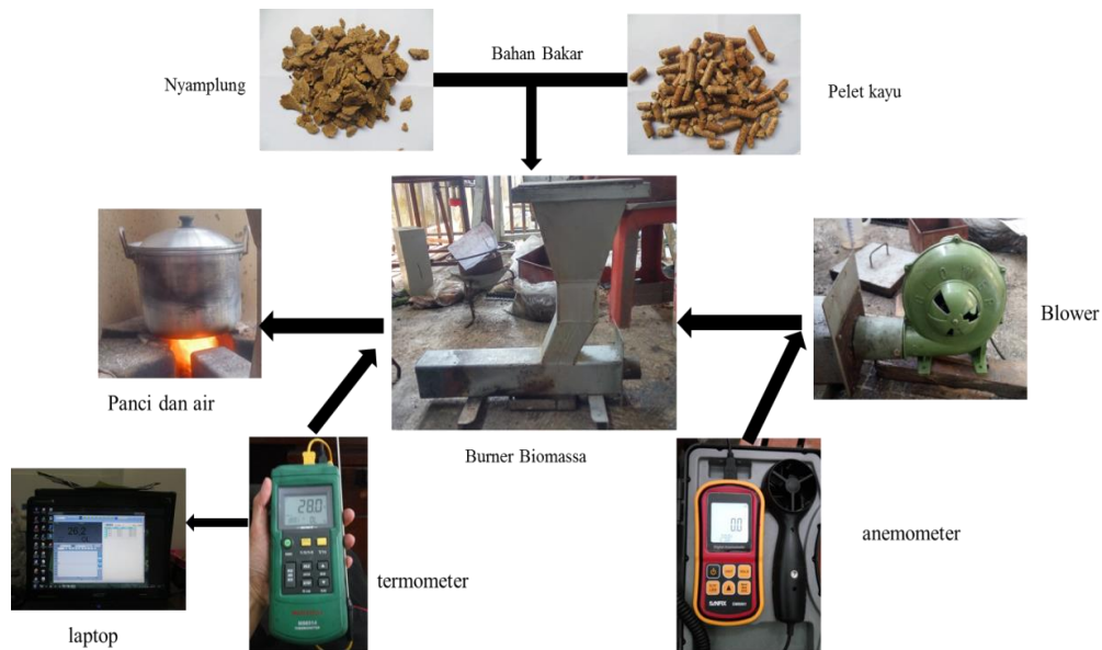
Gambar 2. Diagram alir proses uji coba performa burner biomassa berbahan bakar limbah nyamplung dan pelet kayu.
