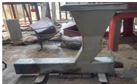
Gambar 6. Hasil fabrikasi burner biomassa.
