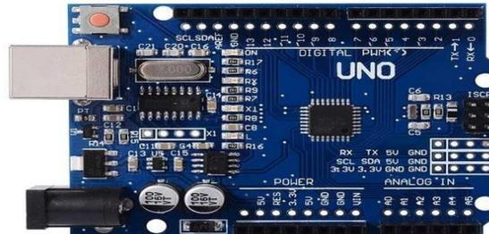
Gambar 2. Tampilan antarmuka Arduino Unu R3.
