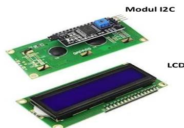
Gambar 3. LCD dengan I2C
